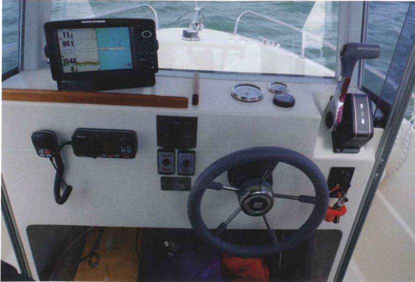
Simple et fonctionnel le tableau de bord permet notamment d'accueillir un combiné sondeur/GPS de bonne taille sur étrier. Une VHF trouve aussi sa place.
