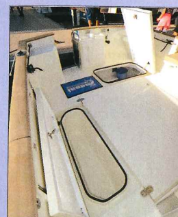
Une banquette biplace est placée devant la timonerie. L'accastillage comprend un davier, des chaumards et des taquets. Des coffres sont accessibles sous le plancher du cockpit.
