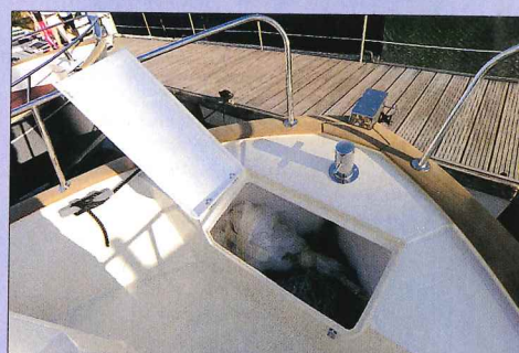
Un grand volume de rangement se situe sous le plancher de la timonerie. La baille montre des dimensions suffisantes pour recevoir une grande ligne de mouillage.
