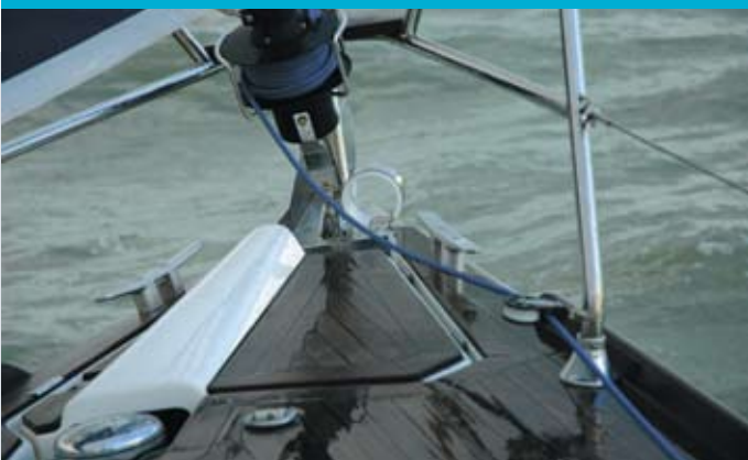
L'anneau de fixation du tangon et son clip de verrouillage
