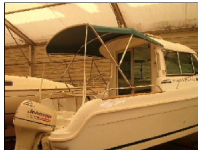
Vue du taud de soleil installé View of the sun awning
